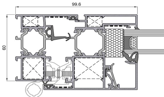
El sistema XP-60, con una sección de 60 mm de canal europeo y RPT de 24mm, es el sistema de la gama Quinarq más versátil. Gracias a su doble escuadra permite realizar todo tipo de cerramientos de ventanas y puertas, manteniendo las mayores garantías.
