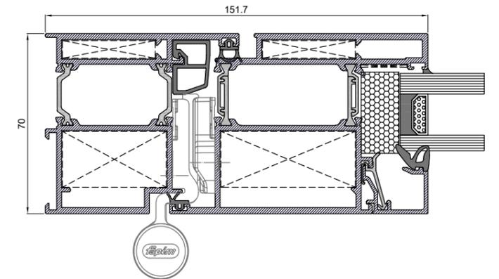
El sistema de puertas de aluminio XD-70 ha sido diseñado para satisfacer las exigencias de cualquier proyecto en términos de aislamiento seguridad y diseño. Con una estética coplanar entre marco y hoja y sus poliamidas anti-bi-metal consigue las mejores prestaciones cuidando el vanguardismo arquitectónico.
