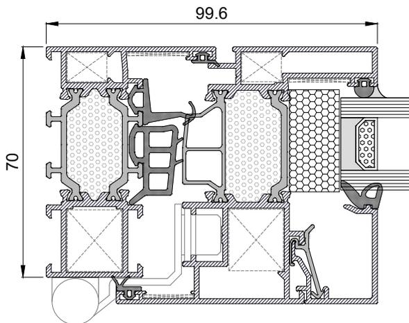
El sistema XP-70+ HI, de 70 mm de canal 16 con RPT de 34 mm y aislamiento térmico HI en cámara, resultan en un sistema de ventanas óptimo. Este sistema cuenta con aislamiento térmico compacto de poro cerrado ocupando toda la cámara.
