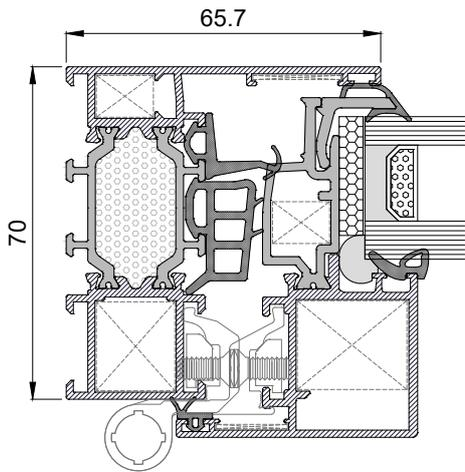
El sistema XP-70 HO HI, con una sección de 70 mm en hoja oculta y RPT de 34 mm. Este sistema cuenta con aislamiento térmico compacto de poro cerrado que ocupa toda la cámara.
